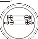
④裏ぶたを【しめる】の方向に回して締めます。
