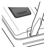
② 押ボタン本体下部の溝から電池カバーをはずします。
